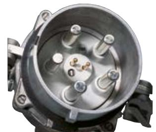
Due contatti pilota si inseriscono standard quando la spina è inserita e si scollegano quando la spina è disinserita. Se richiesto, spine e prese possono essere elettricamente interbloccate.
