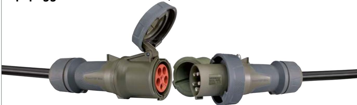
MENNEKES TM spine e prese, colore verde-bronzo RAL6031, sono stati ideati per resistere in condizioni particolarmente difficili. TM spine e prese secondo VG96919 o VG96926 sono adatti per uso in ambienti con temperature da -35°C fino a +60°C. In Ambienti con temperature superiori ai +40°C la corrente nominale deve essere ridotta.
