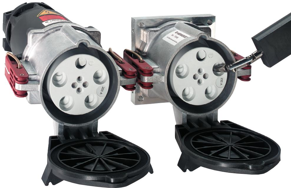
Le prese ad alto amperaggio ampliano la gamma di spine e prese mobili attualmente standardizzate secondo la norma EN 60309-2 con correnti nominali da 160 A a 600 A e tensioni nominali fino a 1000 V. I prodotti sono costruiti secondo le seguenti norme: IEC 309-1, EN 60309-1, DIN VDE 0623, parte 1.
